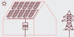
Der Solarstrom vom Dach wird komplett ins öffentliche Netz eingespeist.
